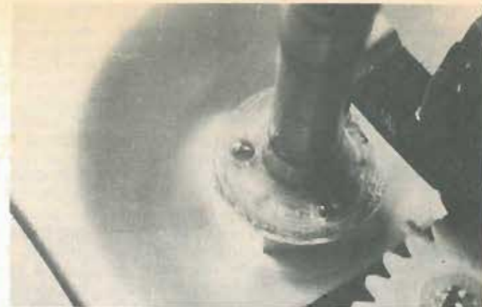
Fig. 6 - Il cuscinetto a sfere reggispinta che la Philips utilizza nei suoi giradischi di alta qualità. La ghiera di fermo delle sfere è di nylon, per avere un buon filtraggio meccanico delle vibrazioni.
